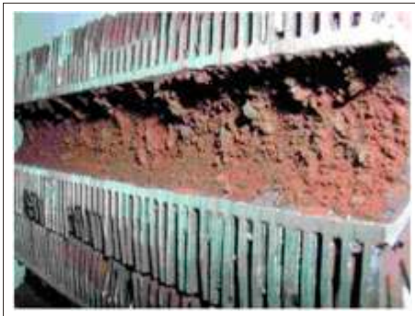
Oksijen korozyonuna uğramış kazan ekonomizer kesiti ve oluşumu
